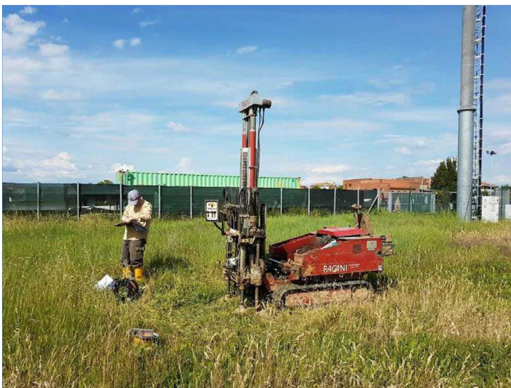
Figura 3: Prova penetrometrica CPT 3
