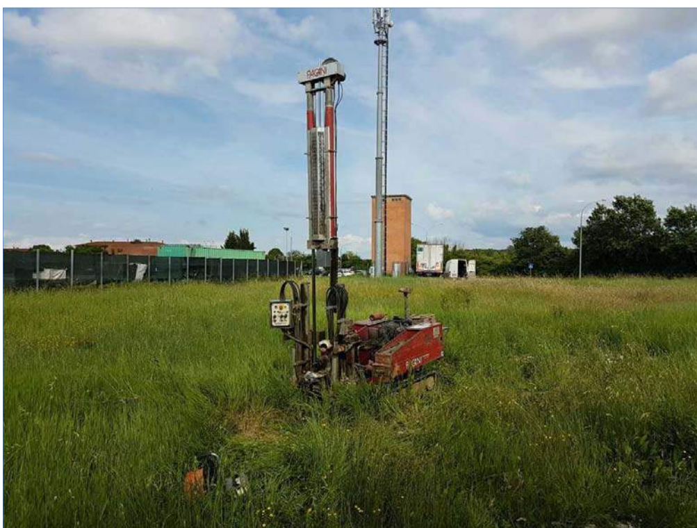
Figura 4: Prova penetrometrica CPT 4
