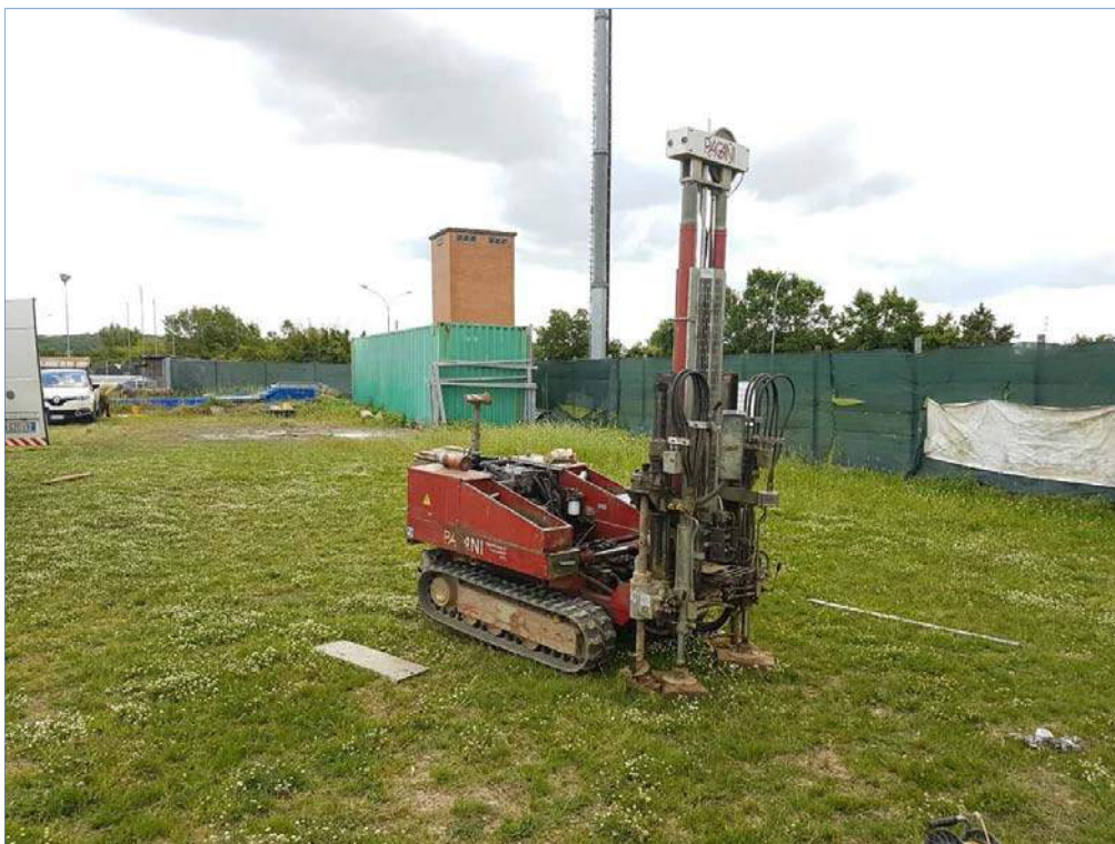
Figura 1: Prova penetrometrica CPT 1
